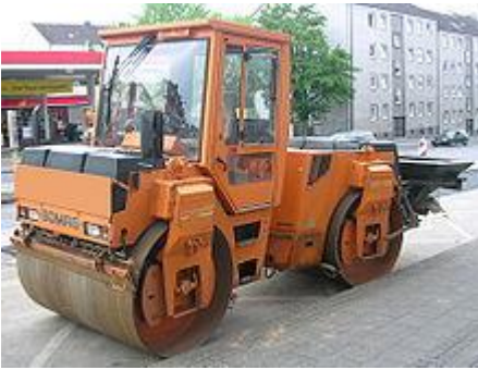
Knickgelenkte Tandemvibrationswalze mit Tellerstreuer im Asphaltbau von 1985
