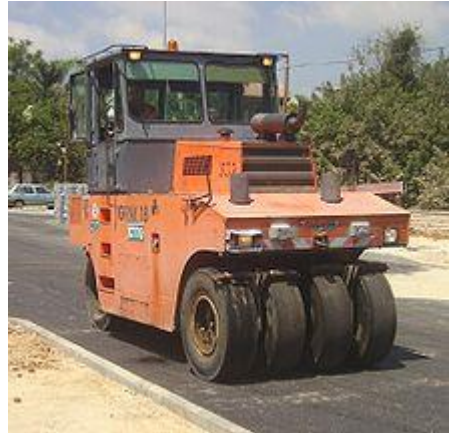
Gummiradwalze mit starrem Rahmen im Straßenbau von 1982
