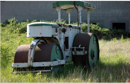
Dreiradwalze mit Dieselmotor aus den 1950-er Jahren
