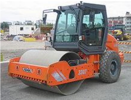
Walzenzug mit Glattmantelbandage und Dieselantrieb von 1976
