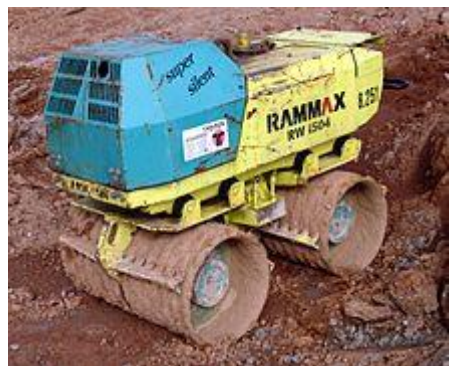
Grabenwalze im Leitungsbau 1985
